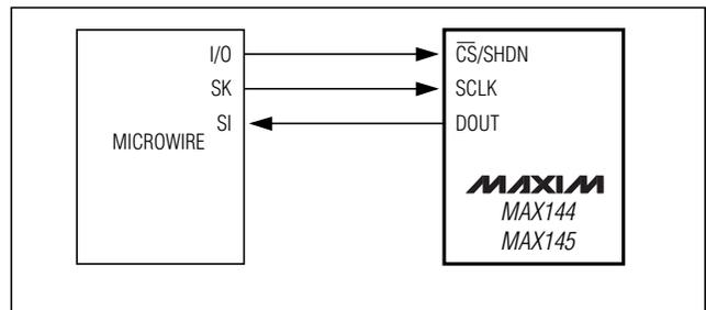
図8b. MICROWIREの接続
