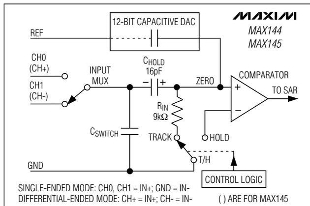
図3. アナログ入力チャンネルの構造
