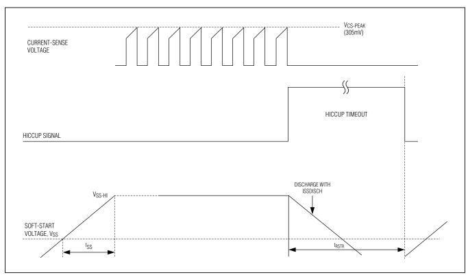
Figure 8. Hiccup-Mode Timing Diagram
