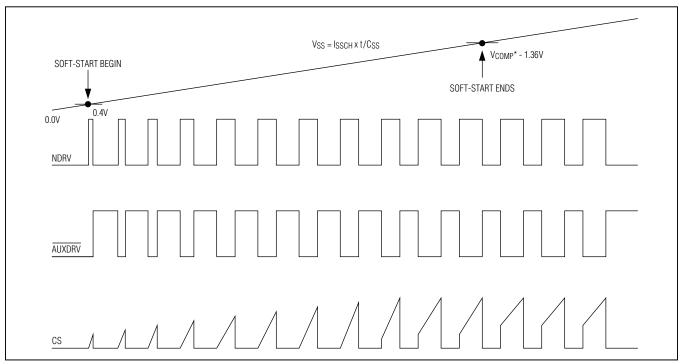
Figure 5. Duty Cycle Soft-Start
