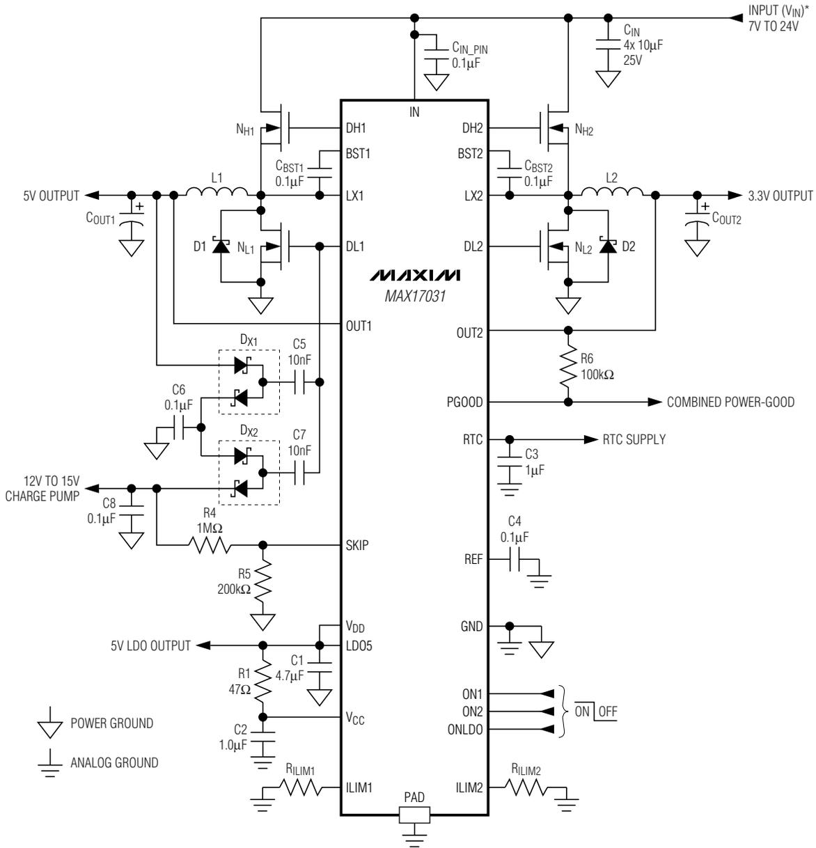
**\*NOTE:** LOWER INPUT VOLTAGES REQUIRE ADDITIONAL INPUT CAPACITANCE. IF OPERATING NEAR DROPOUT, COMPONENT SELECTION MUST BE CAREFULLY DONE TO ENSURE PROPER OPERATION.
