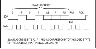
Figure 3. Address Byte
