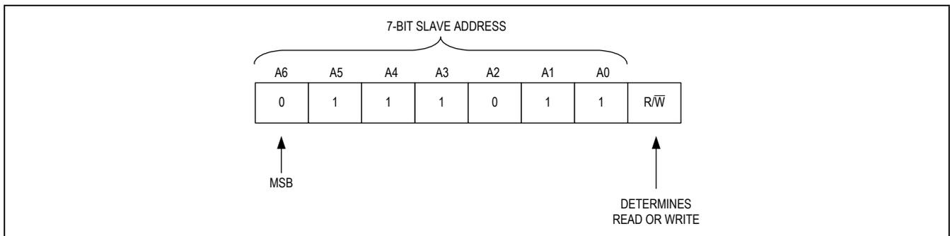
Figure 43. DS2476 I<sup>2</sup>C Slave Address
