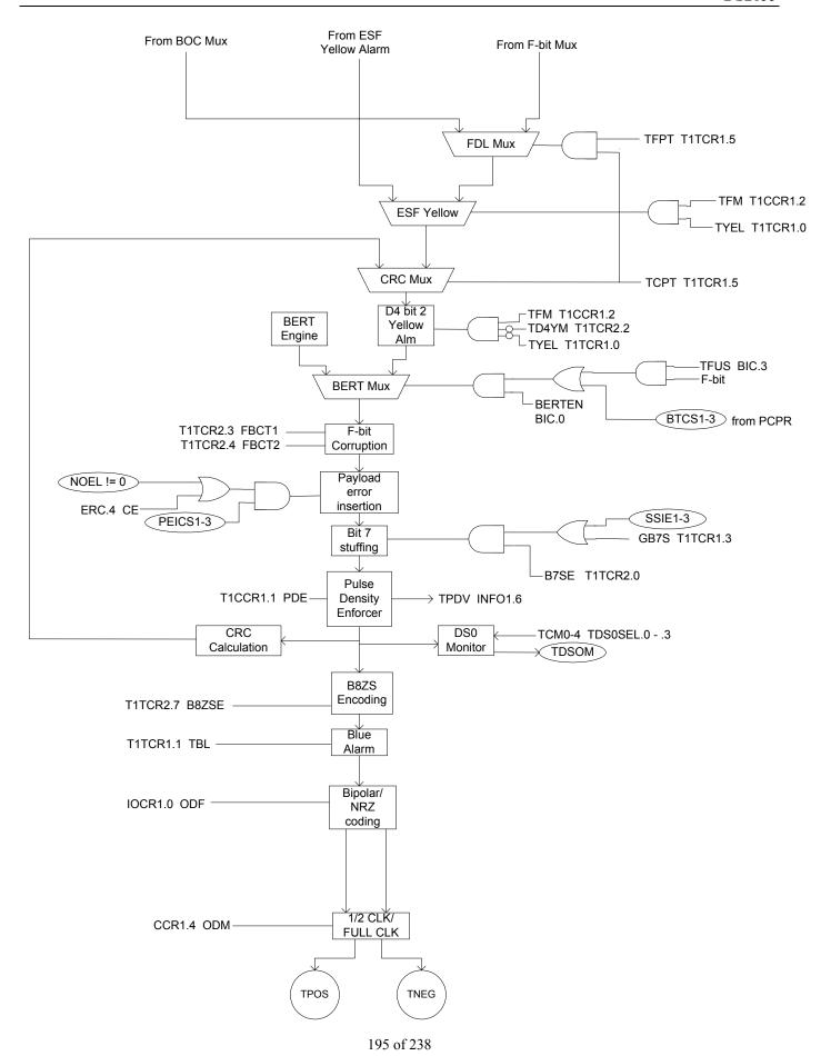
Figure 33-2. E1 Transmit Flow Diagram
