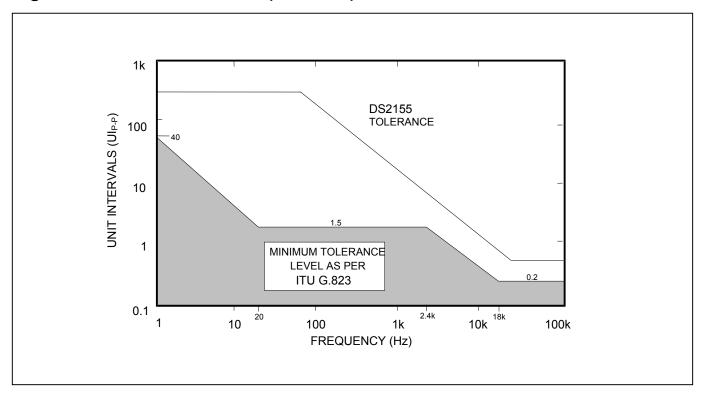
Figure 24-9. Jitter Attenuation (T1 Mode)
