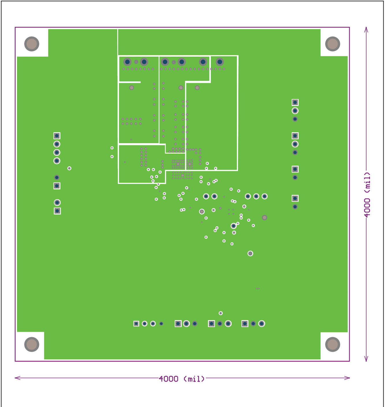
图6. MAX8655评估板PCB布局—内部第3层
