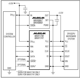
Figure 5. MAX1740/MAX1741 with SPI/QSPI/MICROWIRE Interfaces
