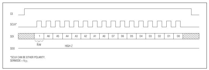
Figure 4. SPI Single-Byte Write
