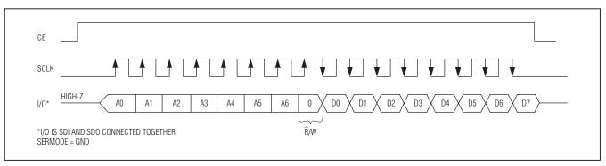
Figure 8. 3-Wire Single-Byte Read
