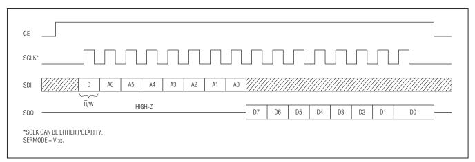
Figure 5. SPI Single-Byte Read
