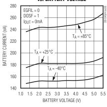
DS1343 BATTERY CURRENT2 vs. BATTERY VOLTAGE
