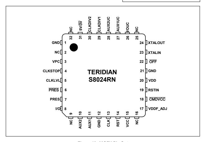
Figure 12: 32QFN Pin Out
