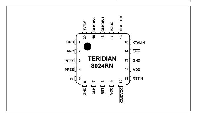
Figure 10: 20QFN Pin Out
