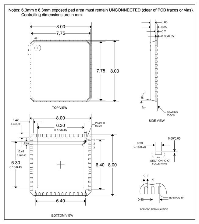
Figure 43: 73S1209F 68 QFN Pinout
